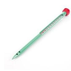
Connaissez-vous le thermomètre de couche ? C'est un appareil qui permet de mesurer la température de la terre.
